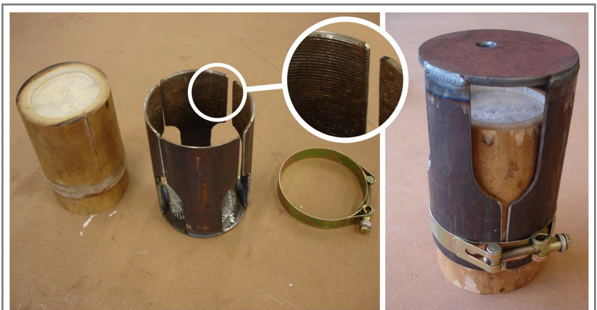
Figura 3.23 Terminal tipo Universal Abrazadera para ensayo.
