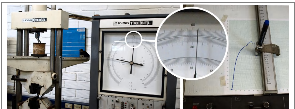
Figura 3.18 Momento de fallo en la prueba de compresión de la terminal de disco con platina sencilla.
