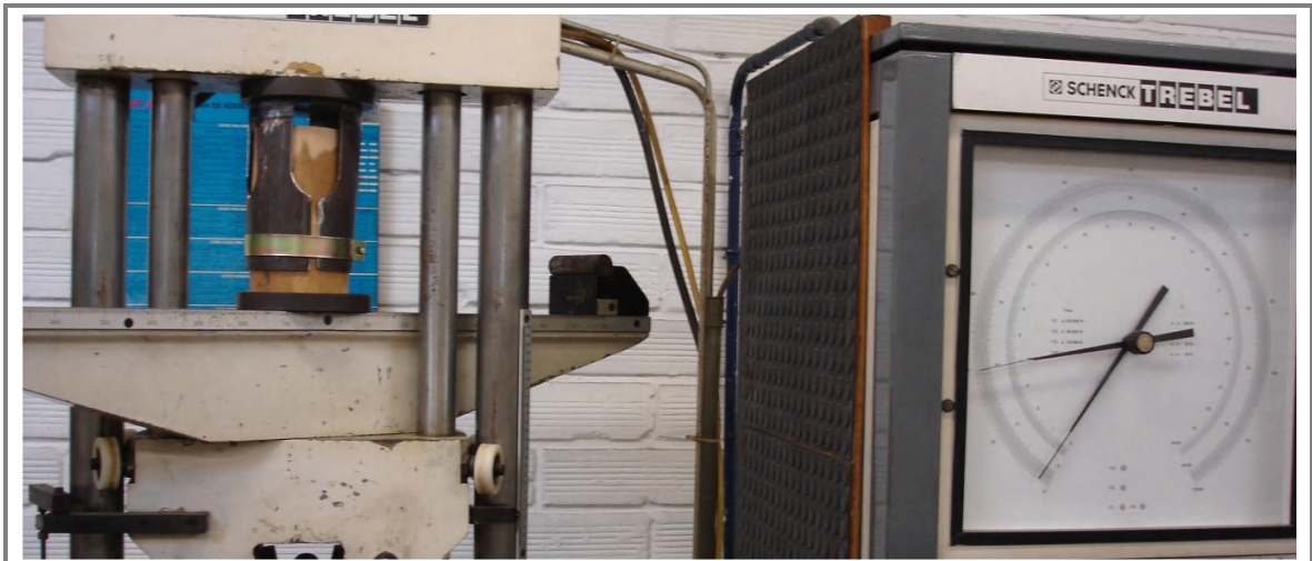
Figura 3.24 Momento de fallo en la prueba de compresión de la terminal tipo Universal Abrazadera.
