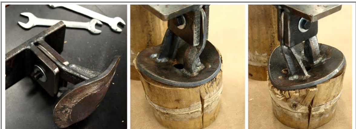
Figura 3.22 Terminal de disco con platina reforzada deformada como resultado de la prueba de compresión.
