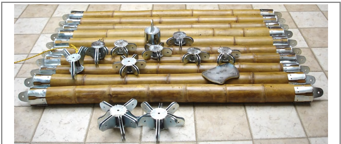
Figura 4.2 Enlaces y nodos fabricados
